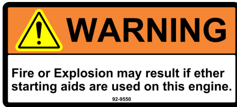
Figura 3. Avviamento con etere vietato (accanto al motore diesel)
